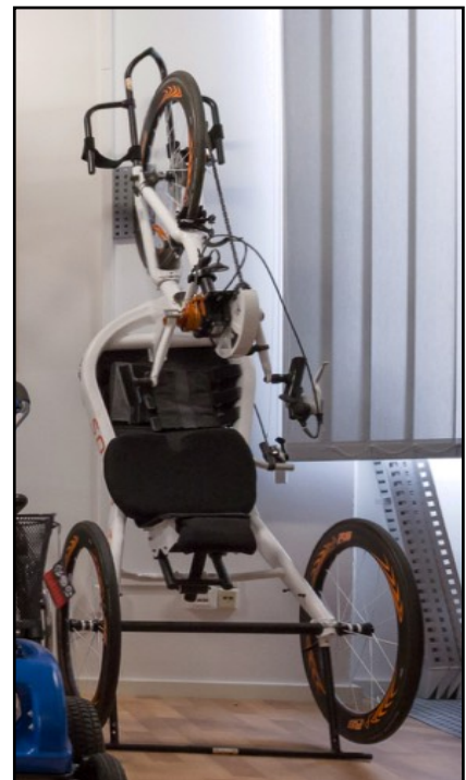
Abb. 33: Skizze und Foto eines an die Wand gestellten Liegebikes (vgl. Rennrollstuhl). Auf 2 m 3 kann ein Liegebike, Rennrollstuhl oder Wurfstuhl abgestellt werden.
