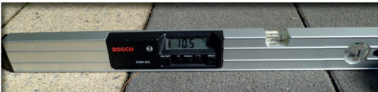
Steigungsmesser zur Überprüfung der Prozentzahl einer Steigung
